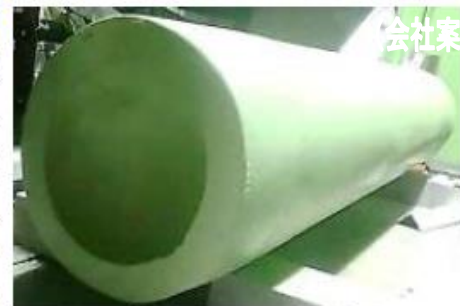
図1: CW 成形法による FRP シリンダータンク
