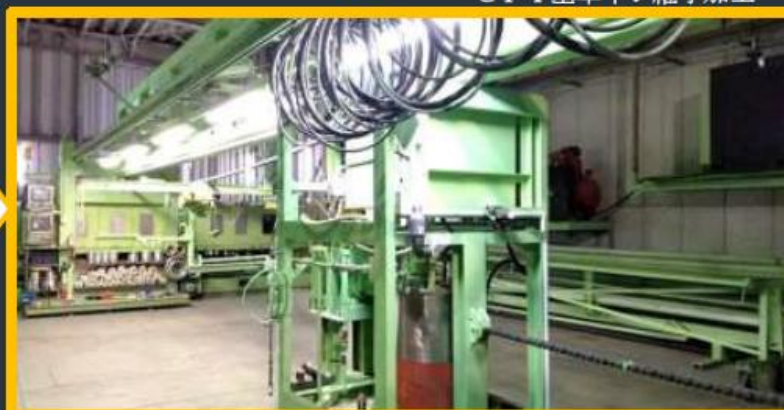
②CW遠心自動成形機 耐圧 100MPa、9.5m管長、2分/1本生産
