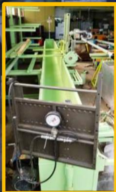
④出荷前の内圧検査機 使用圧力の 1.5 倍 2 分間荷重検査
